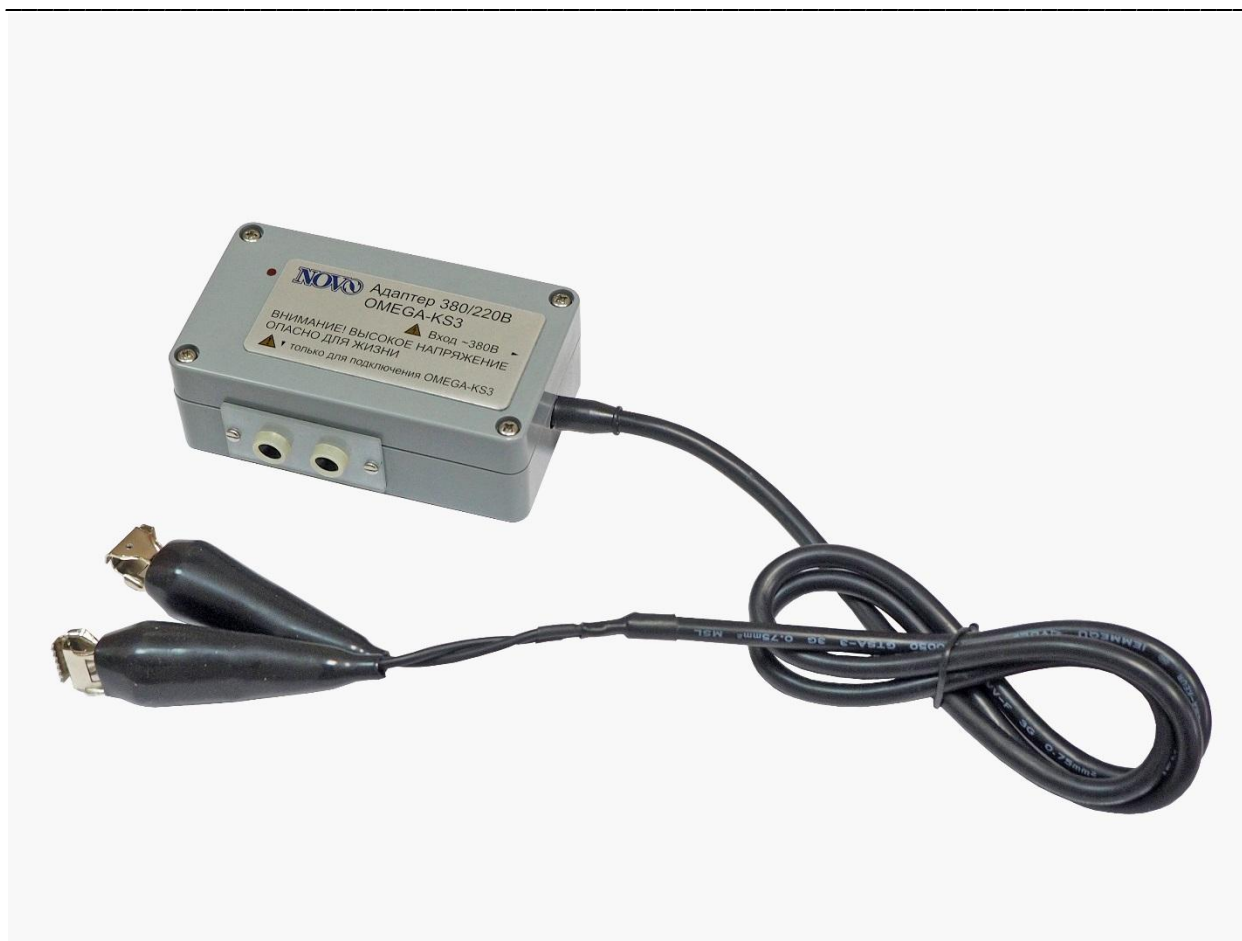
Фото 2. Адаптер 380/220 В конвертера «Омега КС-3».
